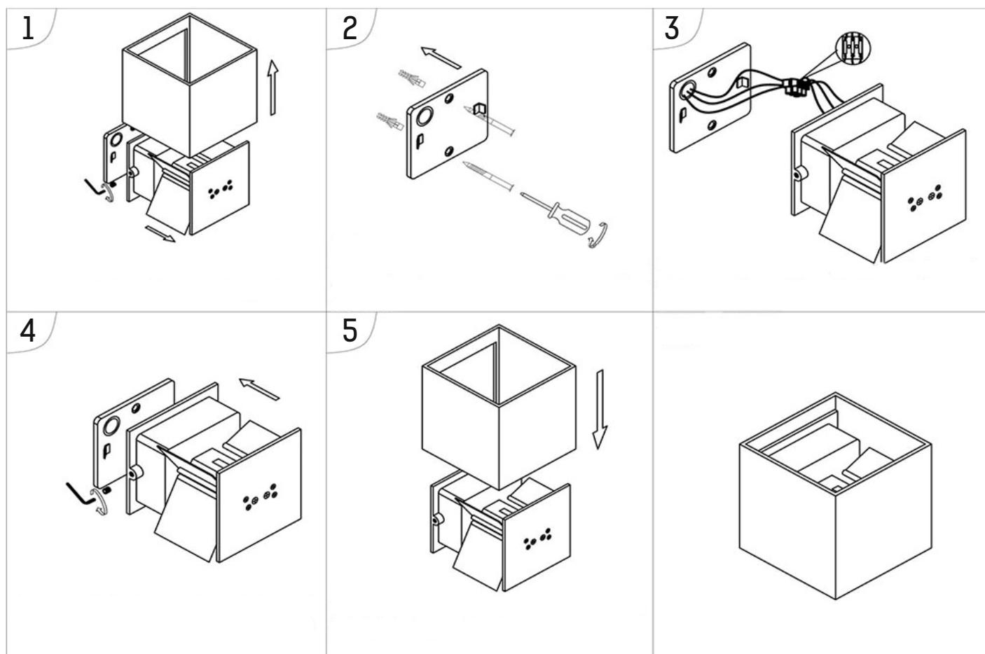
1. Снимите абажур, шестигранным ключом отвинтите винты с обеих сторон и снимите опорную пластину.
